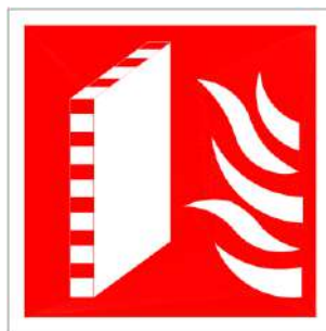
Rys. nr 1. Znak – „Ściana oddzielenia przeciwpożarowego”.
